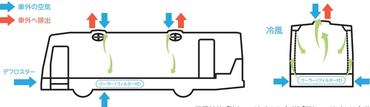
風量性能「強」モード:(5.7m<sup>3</sup>/分)「弱」モード:(4.2m<sup>3</sup>/分)
